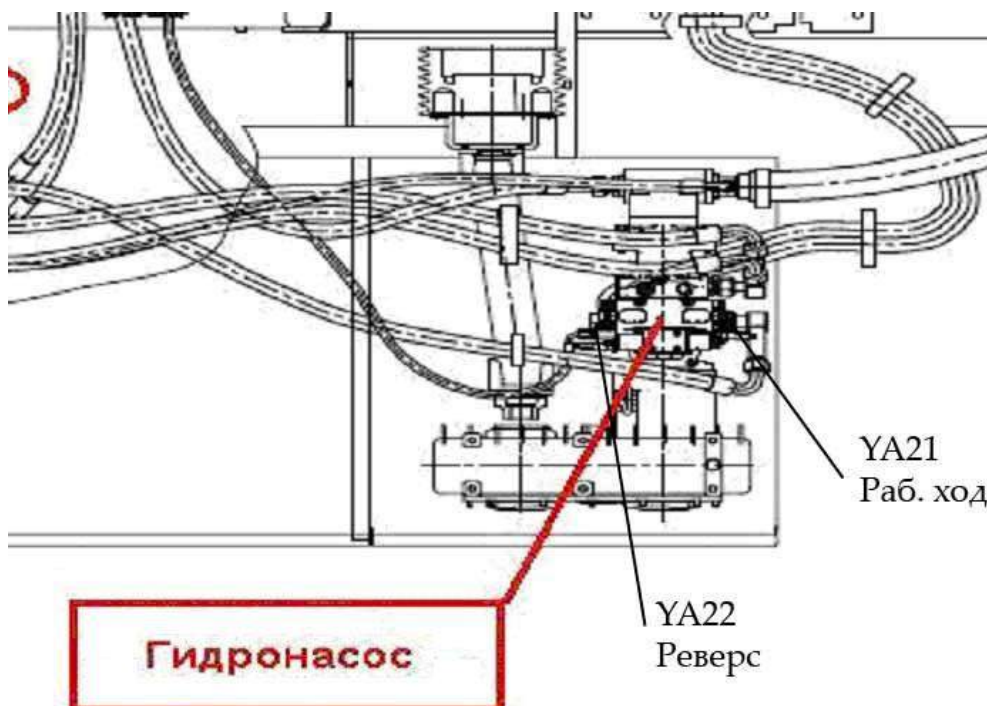
Рисунок М.2 - Расположение магнитов гидронасоса
